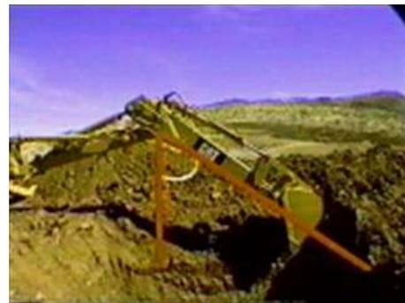
Probablemente con materiales siempre moderados y duros debe de hacer cortes más largos y menos profundos con más movimiento del brazo. En estas condiciones comience con el brazo a un ángulo de 45° grados de la vertical. Después pliegue el cucharón para que penetre los dientes en el material, este ángulo es de más o menos de 90 ° en relación al brazo, baje la pluma hasta que los dientes penetren el suelo.
