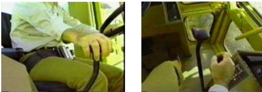
En la parte superior de la palanca se encuentra el control del punto muerto de la transmisión, si necesita más velocidad de la hidráulica del cargador deprima el botón y se desconectaran las ruedas motrices.
