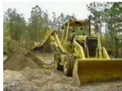
Es muy importante saber que la fuerza de excavación y de levantamiento continúan siendo las mismas con altas y bajas revoluciones, solo la velocidad de los implementos disminuyen a RPM mas bajas.
