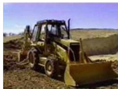
Es importante también mover despacio los controles, evite los movimientos bruscos, la máquina tiene la fuerza suficiente para cargar el cucharón, no fuerce la acción de excavación, velocidad no siempre es la clave para la producción, los movimientos coordinados y suaves lo harán un operador seguro y eficiente y obtendrá los mejores resultados.
