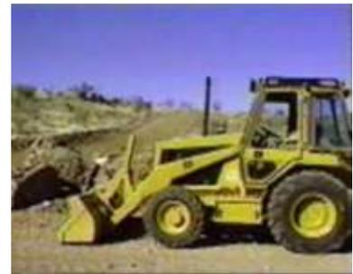
En las tareas difíciles de excavación tal vez desee plegar el lampón para estabilizar mejor el extremo delantero, para girar el asiento tire de la palanca todo hacia atrás y empuje el asiento totalmente hacia atrás, ahora empuje la palanca y gire el asiento hasta dar frente al extremo posterior, ajuste el asiento hasta que se sienta cómodo.
