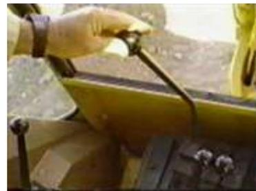
Ponga la palanca de control de aceleración manual en alta en vacío, empuje la palanca izquierda aproximadamente 1 minuto.
