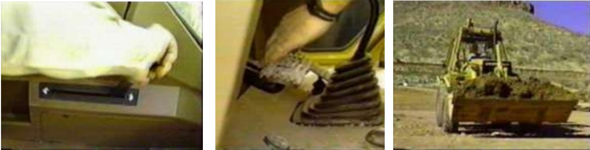
Cuando mueva la máquina guarde la altura de la retroexcavadora para evitar golpear cualquier objeto que esté bajo. De ser posible trabaje hacia arriba o hacia abajo en pendientes en vez de atravesarlas y si tuviera que atravesar la pendiente es necesario que coloque la pluma así el lado contrario de la pendiente para contrarrestar la fuerza de la gravedad;
